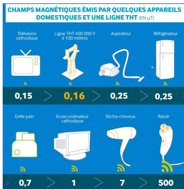
Figure 119 - Exemples d'émissions de champs électriques et magnétiques (Source RTE)
